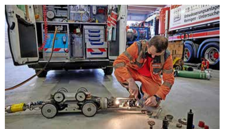
Roslonek Bogumil wechselt den Aufsatz des Roboters. Je nach Einsatz braucht es ein anderes Werkzeug.
